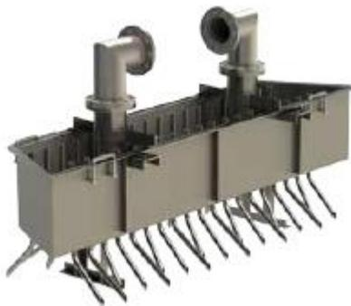
El distribuidor de líquido **MaxiFlow** de Clark Solutions se ha desarrollado para optimizar la transferencia de masa de gas líquido. Este consiste de varios canales en paralelo con innumerables puntos de irrigación independientes. Por presentar alta tasa de irrigación, el **MaxiFlow** genera uniformidad en la distribución del líquido, lo que evita regiones de bypass del gas y favorece alta tasa de transferencia de masa.
