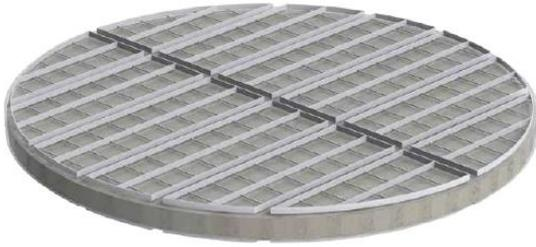
**MaxiMesh®** es un eliminador de niebla que consiste en un conjunto de mallas de hilos tejidos (en uno o más material) apoyado por rejillas con una amplia área abierta. Fabricado en cualquier acero inoxidable, aleaciones especiales o plásticos y en cualquier tamaño y forma, el eliminador de neblinas **MaxiMesh®** es adecuado para todos los tipos de aplicaciones que requieren alta eficiencia (remoción del 99,9% de partículas con 3  $\mu\text{m}$  o más) y la capacidad media de Gas y líquido.
