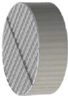
Este separador líquido-líquido consiste en una modificación en el eliminador de niebla **MaxiMesh®** original, con un enfoque de separación líquida. En vez de coalescer las gotas, dejándolas sedimentar, funciona como una malla de aglomeración, haciendo que gotas menores de 30 $\mu\text{m}$  coalescen hasta más de 100  $\mu\text{m}$ , que se decantarán más rápidamente.
