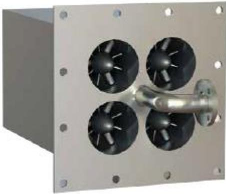
HeliFlow® son ciclones axiales de alto rendimiento, que consiste en un sistema en paralelo de múltiples tubos con láminas anguladas en el interior, las cuales obligan al gas a fluir en espiral dentro de los tubos. El efecto de rotación crea una presión diferencial del centro para los bordes de los tubos, donde existe un sistema de drenaje para recolección de gotitas, las cuales fluirán separadas de la fase gas.
